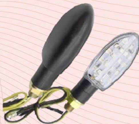
MODELO(TR7): 1024 EMARK TIPO: LUZ INTERMITENTE ESPECIFICACIÓN: 18LED-2CABLES
